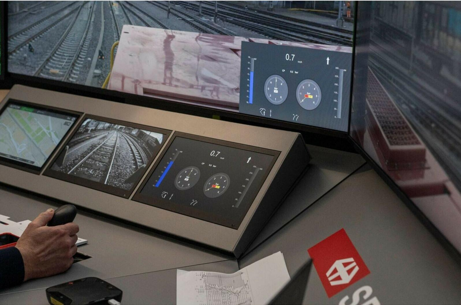
Les CFF ont effectué des essais en exploitation avec une locomotive télécommandée
